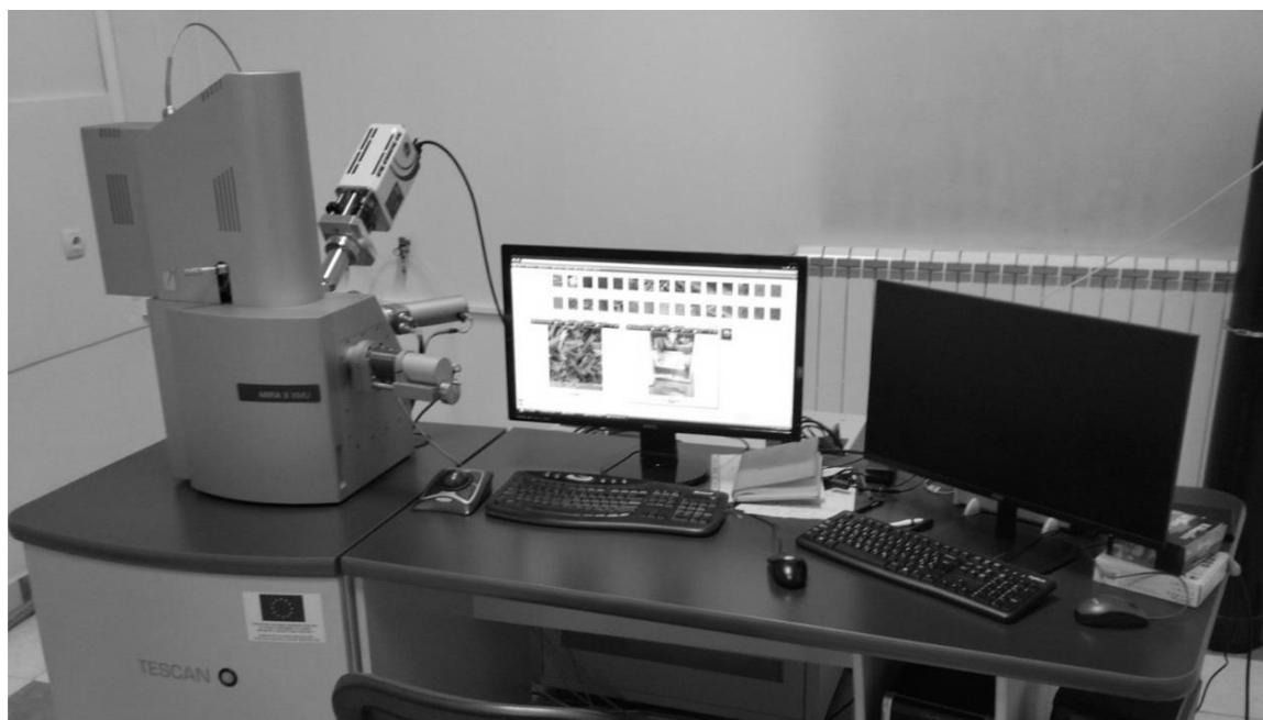
Слика 18. MIRA3 TESCAN емисиони скенирајући електронски микроскоп
