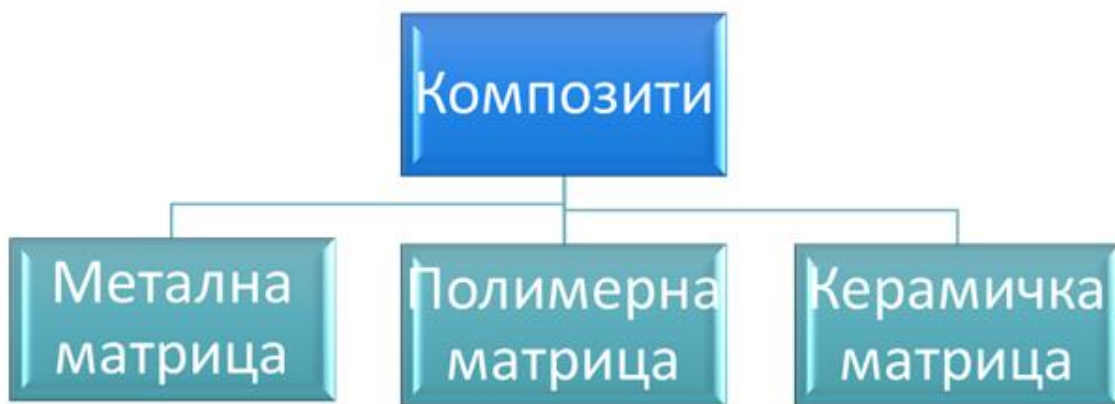
Слика 11. Класификација композитних материјала према типу матрице
