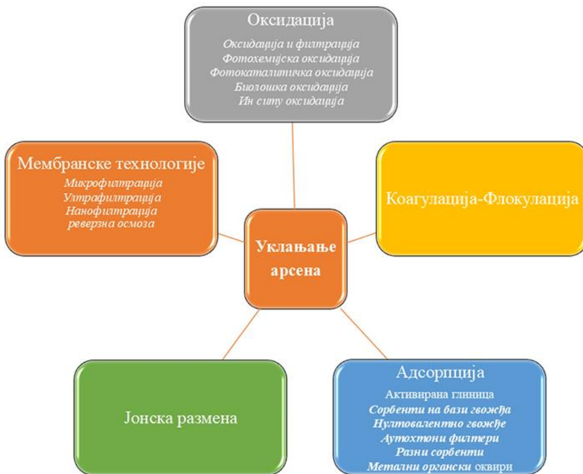
Слика 7. Различите технике које се користе за уклањање арсена из воде [118]
