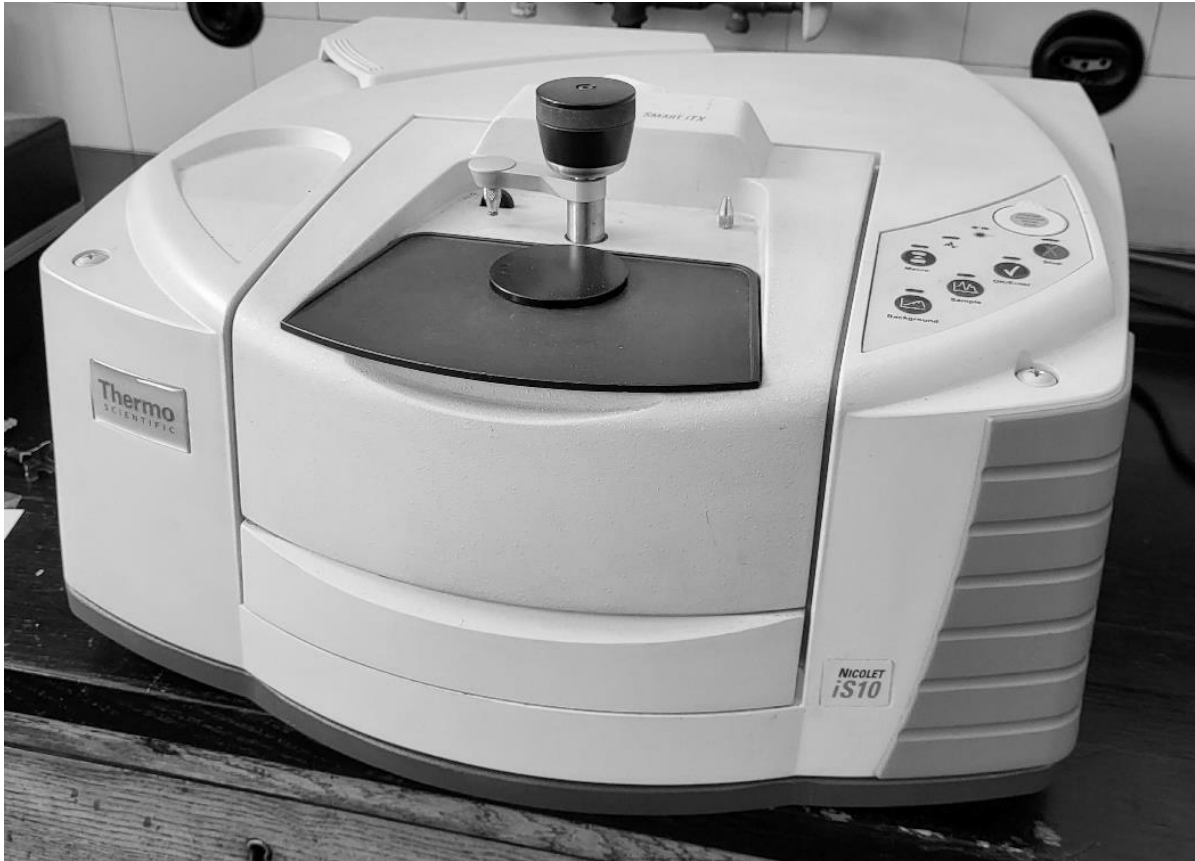
Слика 19. Thermo Fisher Scientific Nicolet IS-50 спектрометар
