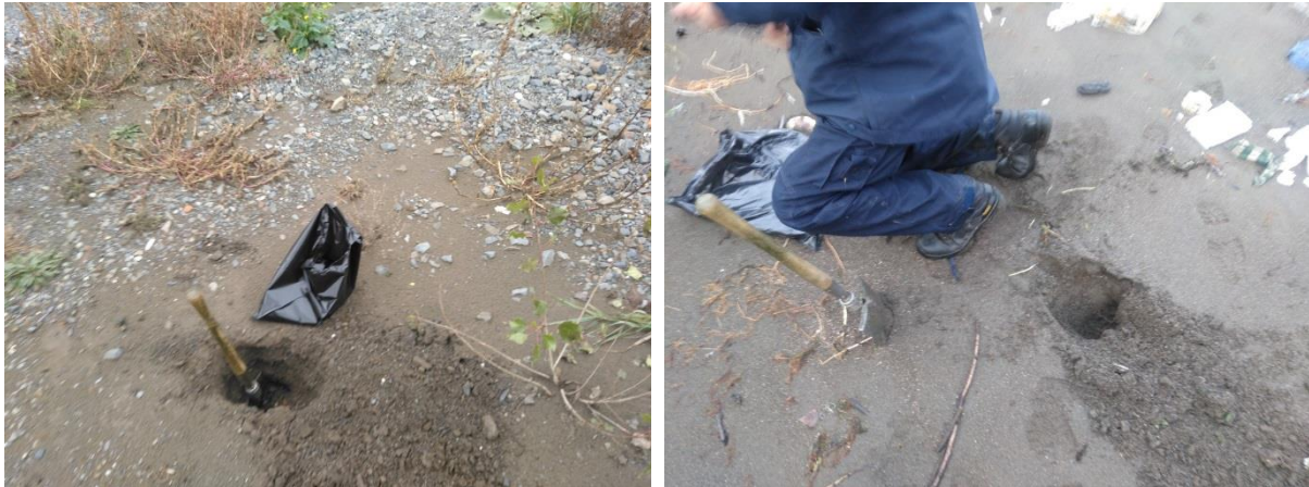
Slika 7: Prikupljanje uzoraka iz sedimenta aluviona rijeke Lim
