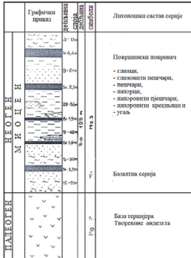
Slika 3.17. Šematski prikaz geološkog stuba ležištakamenog uglja“Progorelica” i “Tadenje” [Lojanica V., 2013]
