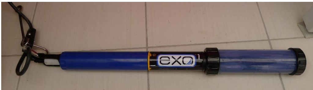
Слика 14. Мултипараметарска сонда EXO1 коришћена приликом узорковања (фотографисао Горан Кнежевић)
